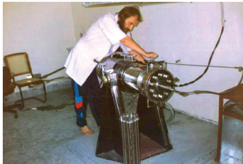
▲ В индийской лаборатории Георгий Бичуров смонтировал реактор для получения нанопорошков.
