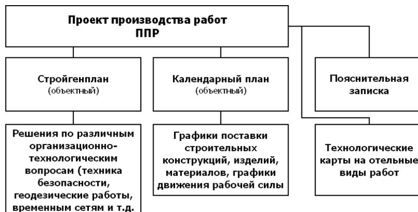
Рис. 2. Проект производства работ
