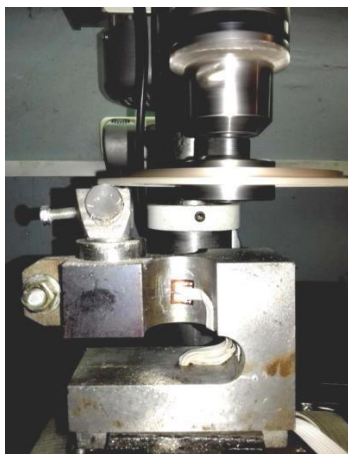
Рис. 2. Испытание зубков на абразивное изнашивание из-за трения об алмазный отрезной диск
