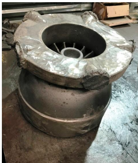
Рис. 4. Отливка «Аппарат направляющий» по технологии заливки в комбинированные формы на базе ООО «НПП «СовТехЛит»
