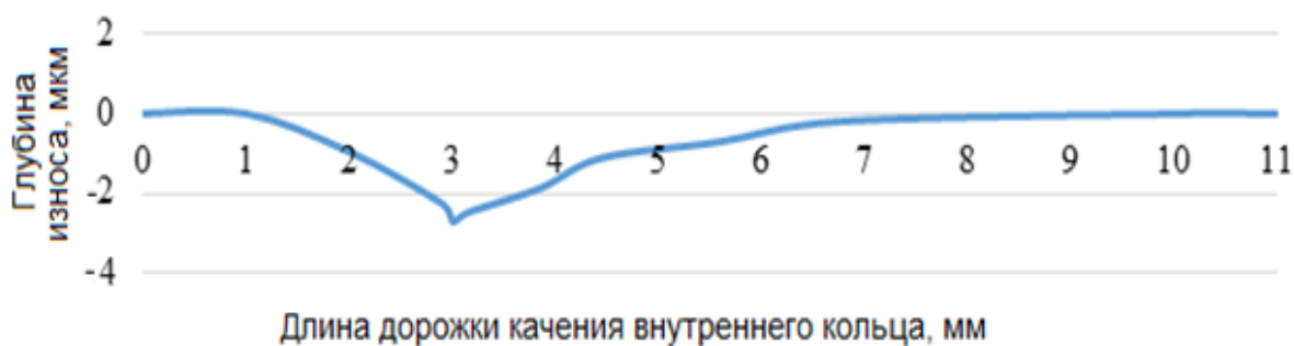
Рис. 3. Распределение глубины износа внутренней дорожки качения за 25000 часов эксплуатации
