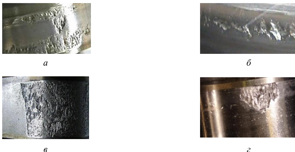
Рис. 7. Наружный облик контактной поверхности образца после испытаний: a – N = 8,4 \cdot 10^7 циклов материал 20Х3МВФ-Ш; б – N = 1,4 \cdot 10^6 циклов материал 20Х3МВФ-Ш; в – N = 1,3 \cdot 10^7 циклов материал 20Х3МВФ-Ш; г – N = 5,4 \cdot 10^6 циклов материал 12Х2Н4А-Ш
