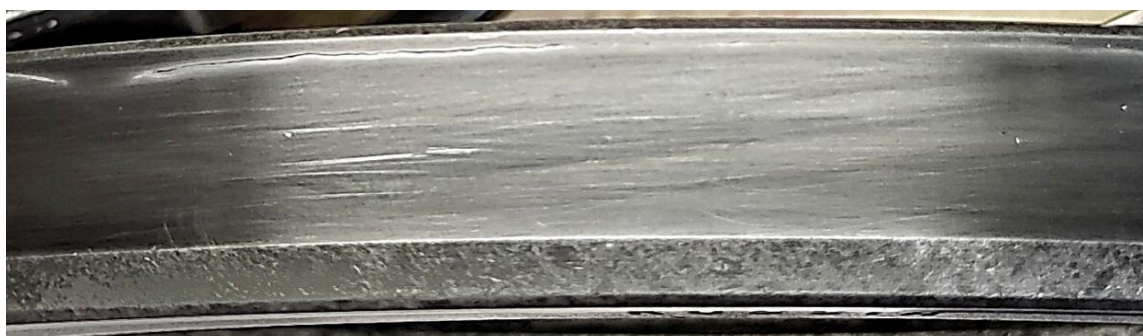
Рис. 4. Внешний вид трещин после холодного травления
