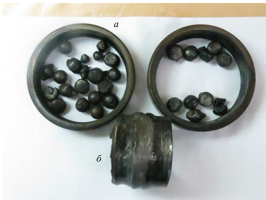
Рис. 1. Общий вид деталей исследуемого подшипника: а – наружные кольца с шариками и фрагментами шариков, б – приваренные друг к другу внутренние кольца
