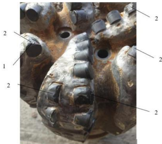
Рис. 1. Повреждение PDC зубков в ходе эксплуатации: 1 – хрупкие сколы режущих кромок; 2 – абразивное изнашивание
