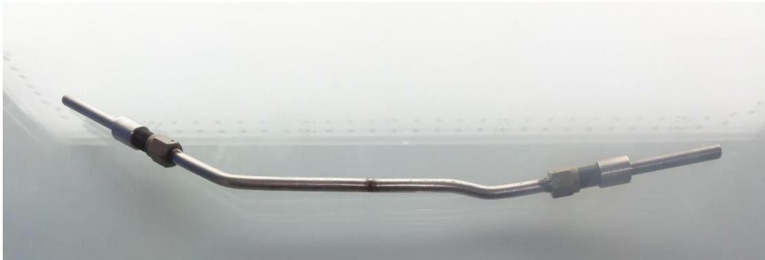
Рис. 2. Эталон части трубопроводной системы
