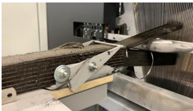
Рис. 3. Изготовление преформ из углеродного волокна
