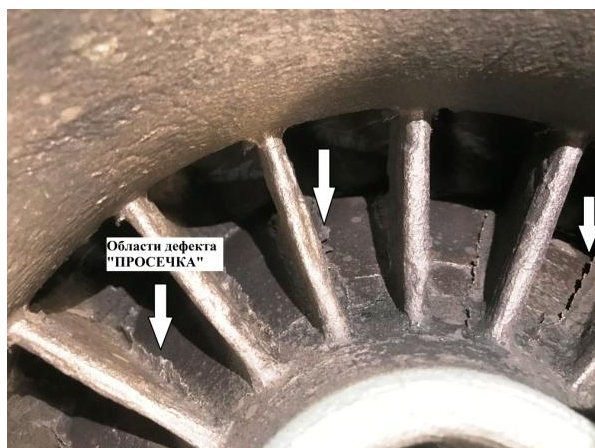
Рис. 5. Дефект литья в виде просечек
