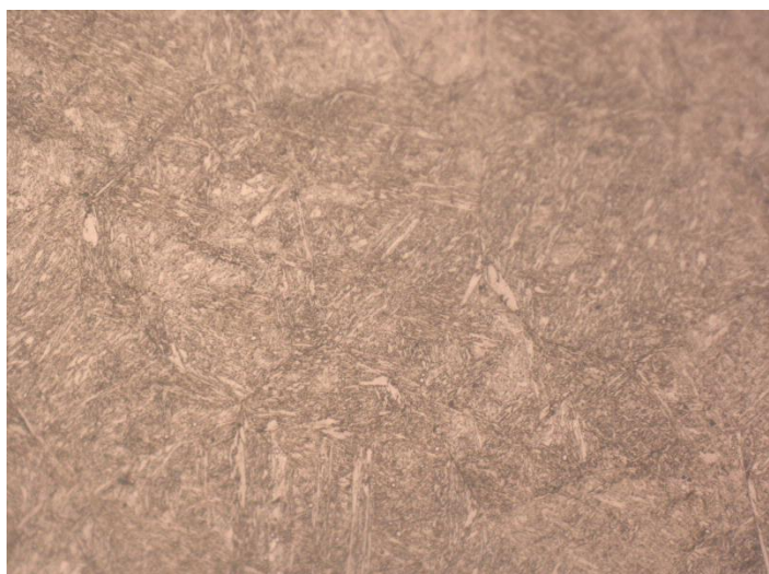
Рис. 1. Микроструктура стали 30X13 после упрочняющей термической обработки (X500)
