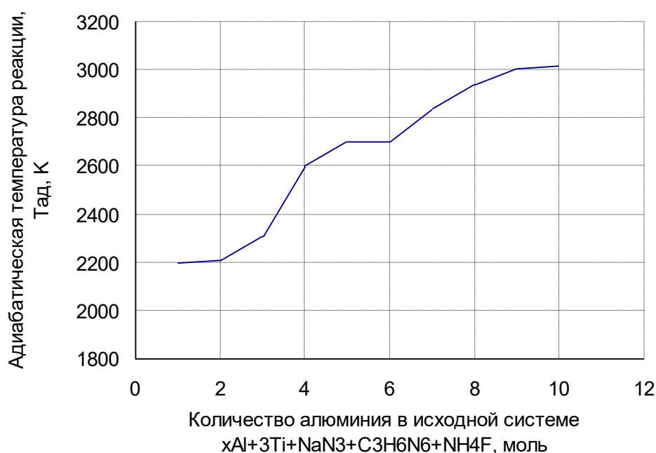
Рис. 2. Зависимость адиабатических температур реакций (1)–(10) от количества исходного алюминия
