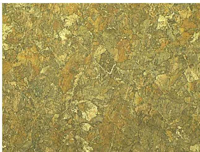
Рис. 5. Микроструктура внутренних колец и шариков \times 500
