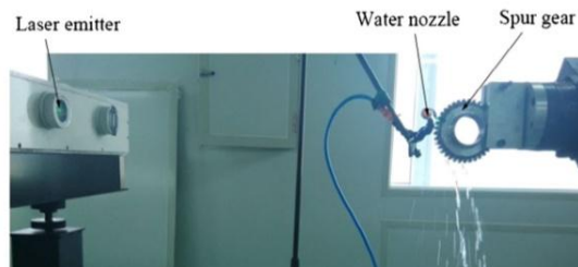
Рис. 1. Процесс ЛУО основания шейки зуба шестерни трансмиссии [5]
