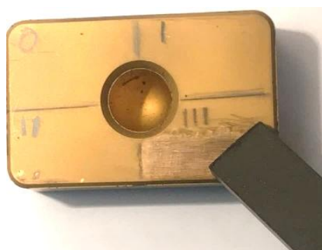
Рис. 2. Процесс полировки твердосплавной пластины
