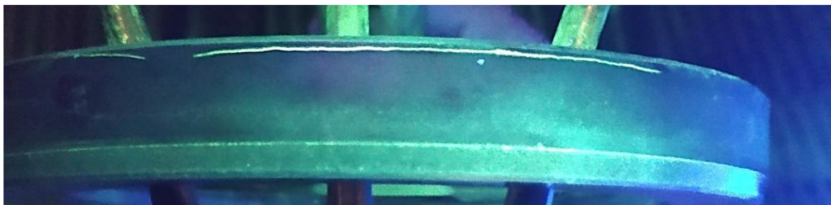
Рис. 2. Индикаторные рисунки после магнитно-люминесцентной дефектоскопии
