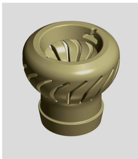
Рис. 2. Аддитивный песчаный стержень для производства отливки «Аппарат направляющий» методом литья
