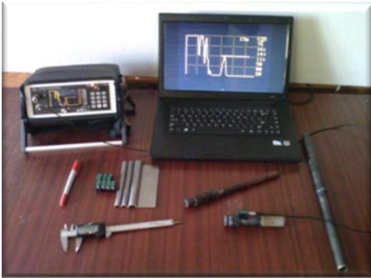
**Назначение** – диагностика трубопроводных систем контрольно-измерительных приборов технологических установок на предприятиях химической и нефтехимической промышленности. Объектами диагностики являются тонкостенные (2-3мм) трубные элементы малого диаметра (14-20мм).
