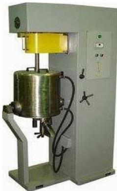
Мы предлагаем **разработку и организацию производства гранулята** из любого металлического порошка со связующим на основе полиформальдегида для изготовления деталей по МИМ-технологии. Для производства гранулята имеется современное высокотехнологичное оборудование: атриттор-1/0,03-ОК-Р102, смеситель с Z образными лопастями - типа ЗЛ (СРК) и валковый гранулятор BSW 100.
