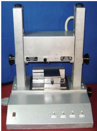
Диагностический программно-аппаратурный комплекс предназначен для экспрессной диагностики фактического состояния и прогнозирования остаточного ресурса конструкционных материалов, применяемых в машиностроении, энергетике, на транспорте, подверженных при эксплуатации изнашиванию, усталости, наводороживанию.
