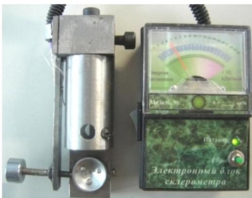
Прибор, позволяет выполнять количественную оценку прочности сцепления покрытия с основой на срез и на отрыв.
