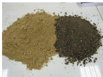
Грунтоподобный материал на основе пастообразных отходов
