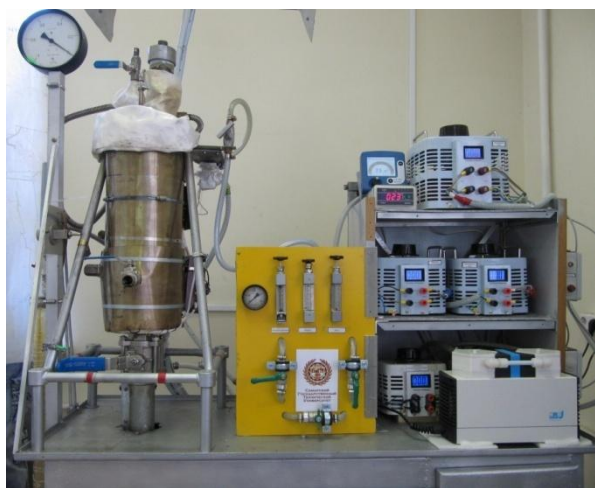
Лабораторная установка переработки нефтешламов
