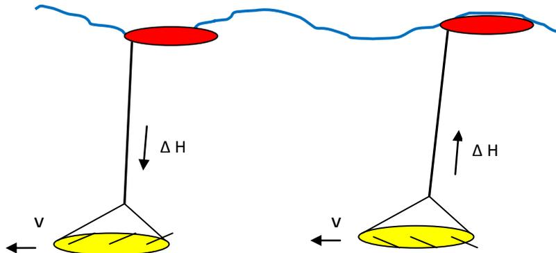
Снабжена свободно поворачивающимися плавниковыми движителями (крыльями), которые, используя энергию набегающей волны, двигают **ПОДВОДНУЮ ЧАСТЬ** вперёд и тянут за собой **НАДВОДНУЮ ЧАСТЬ**.
